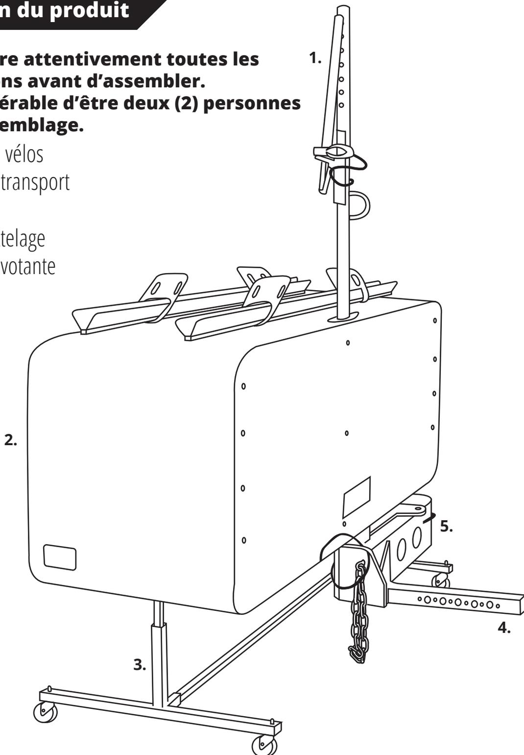
**Pour installer un coffre NICOVA, l'attache-remorque du véhicule doit être certifiée de classe 3 ou plus, et être en bon état.**
