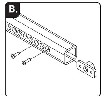
2. Couper la partie superflue sur la barre d'attelage, au besoin, en laissant au moins 2 1/2po entre le trou choisi et l'extrémité de la barre
