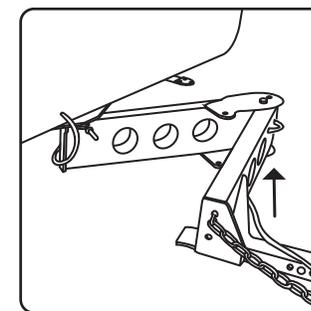
**⚠ Attention! Avant de passer à l'étape 5, il est très important de s'assurer que le coffre est au niveau par rapport à l'attache-remorque. Par exemple, soulever le coffre à la hauteur de la penture facilite grandement la tâche.**
