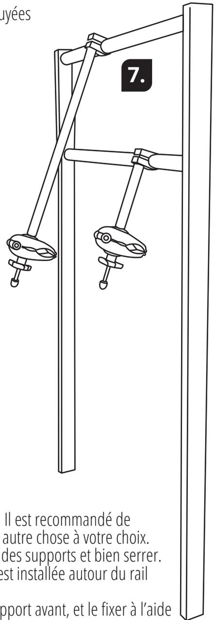
4. Positionner la pince courte sur le cadre (ajuster sa hauteur, au besoin). Il est recommandé de protéger le cadre avec les bandes de caoutchouc fournies à cet effet ou autre chose à votre choix.
