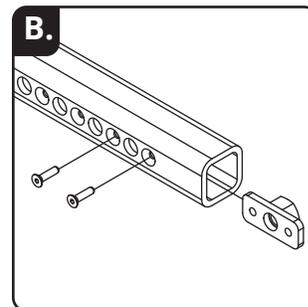
2. Couper la partie superflue sur la barre d'attelage, au besoin, en laissant au moins 2 1/2po entre le trou choisi et l'extrémité de la barre
